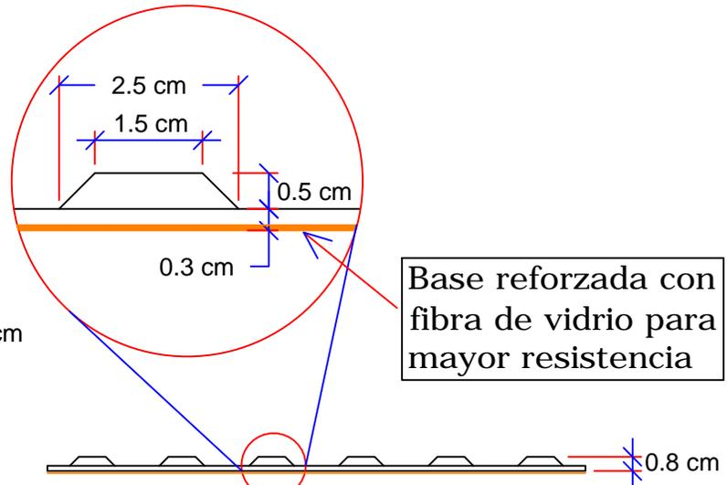
**"Diseñada para instalarse de manera superficial sin necesidad de excavar piso existente"**
