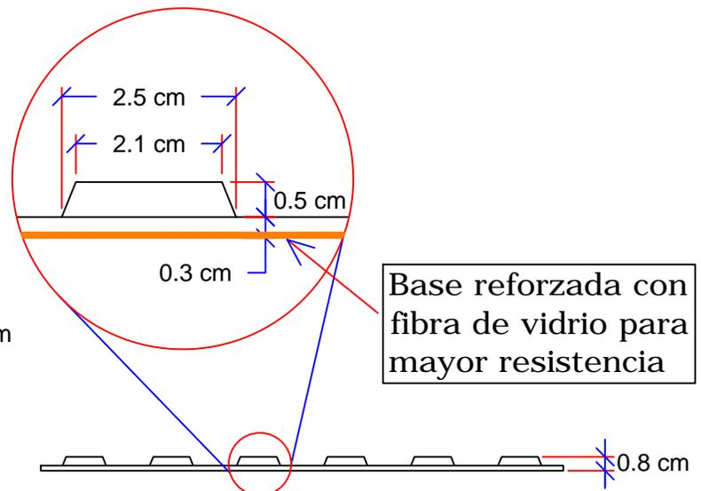
**"Diseñada para instalarse de manera superficial sin necesidad de excavar piso existente"**
